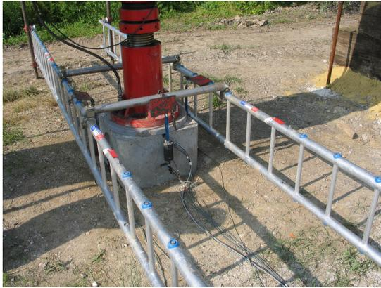
Figure 12a Comparateurs et bases fixes
