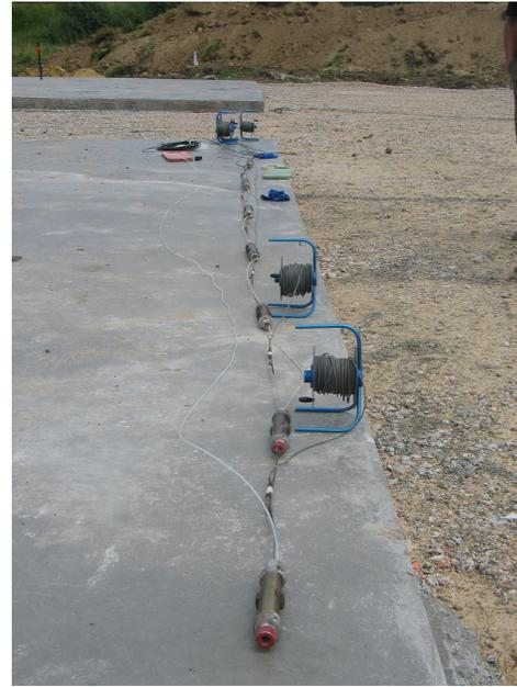
Figure 12b Assemblage de l'extensomètre
