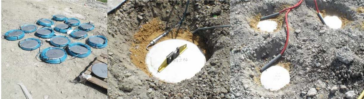
**Figure 16. Capteurs de pression totale**
