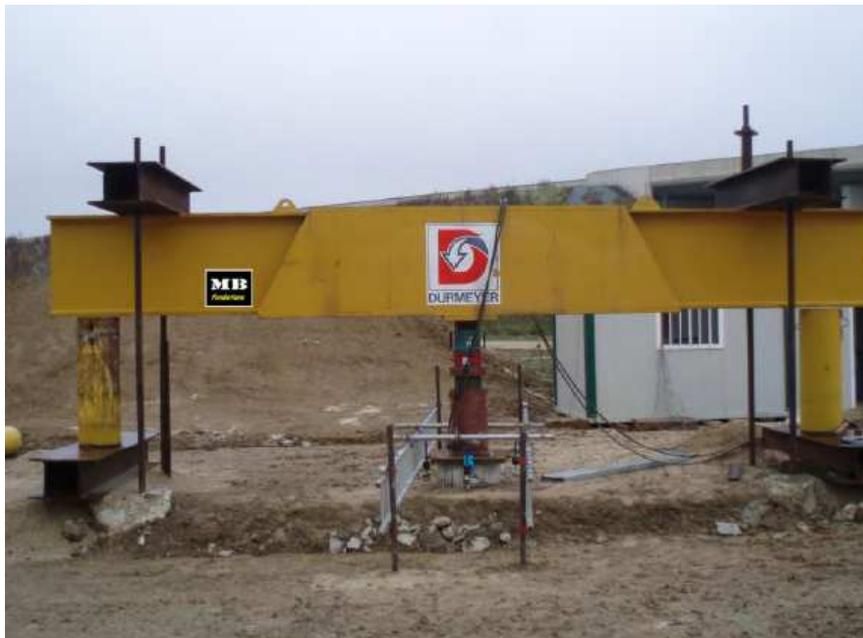
Figure 14. Essai de chargement (MB Fondations)
