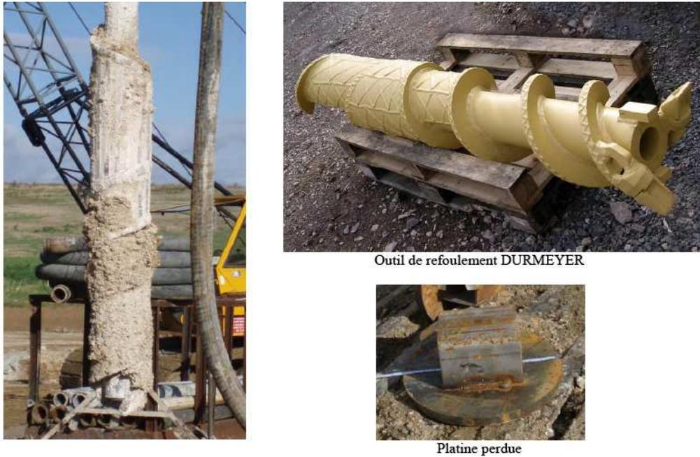
**Figure 2 – Dispositif de réalisation des inclusions rigides**
