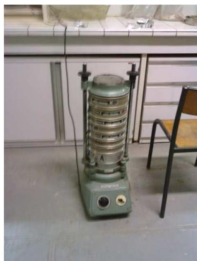
A la sortie de l'étuve, la colonne de tamis contenant le sol est placée sur la tamiseuse électrique pendant 20 min. Les refus des tamis sont ensuite pesés.
