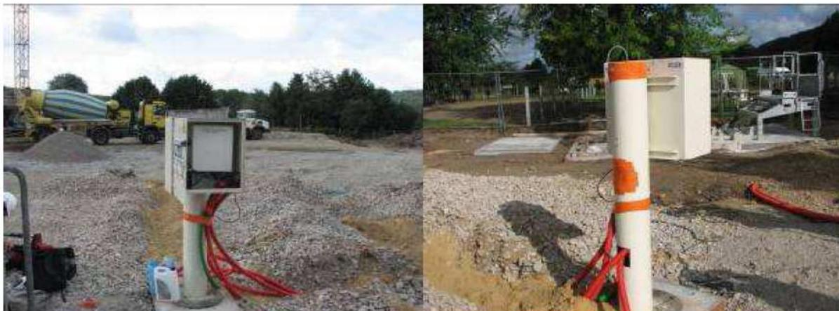
Figure 7. Plot de référence et centrale d'acquisition
