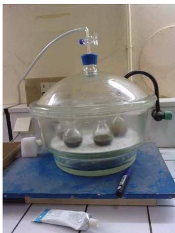
Photo 8 : Cloche à vide contenant des pycnomètres.
