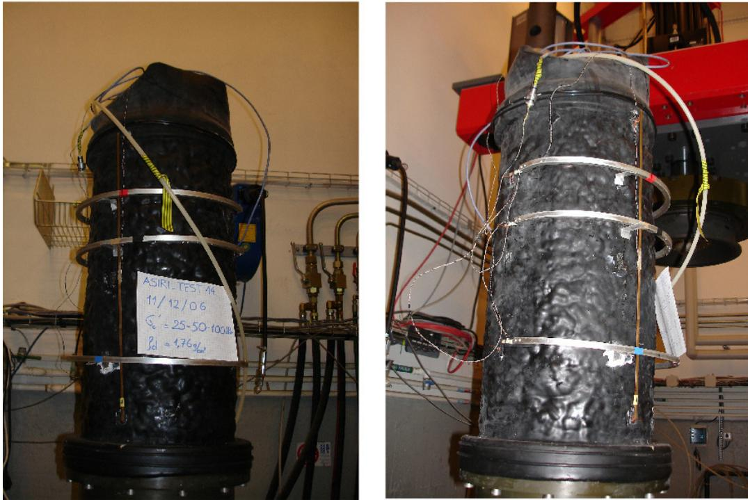
Figure 36 – Vues du dispositif de mesure locale des déformations installé sur une éprouvette (essai 10)
