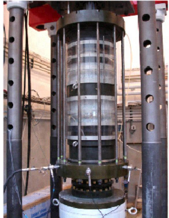
Figure 12 - Vues des différentes phases de préparation d'une éprouvette triaxiale 300 mm
