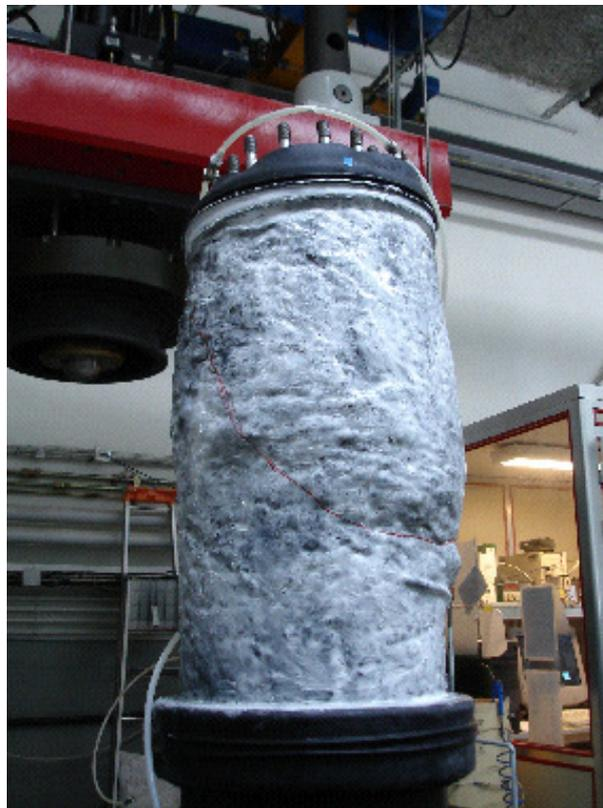
Figure 17 - Vue de l'éprouvette après essai (essai 3)
