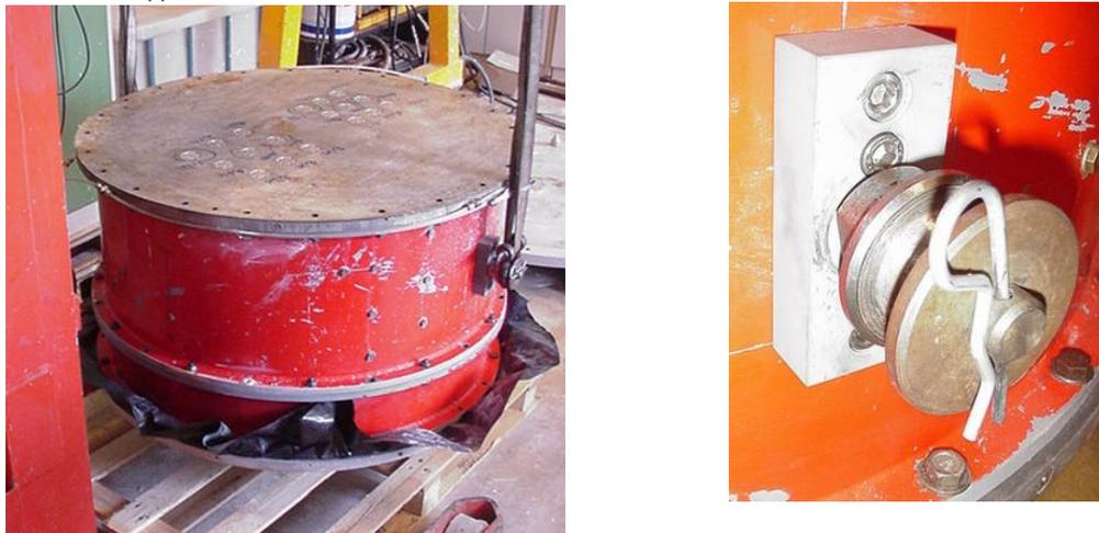
Figure 12 - Tourillons disposés sur 2 génératrices opposées pour assurer le retournement du conteneur d'argile
