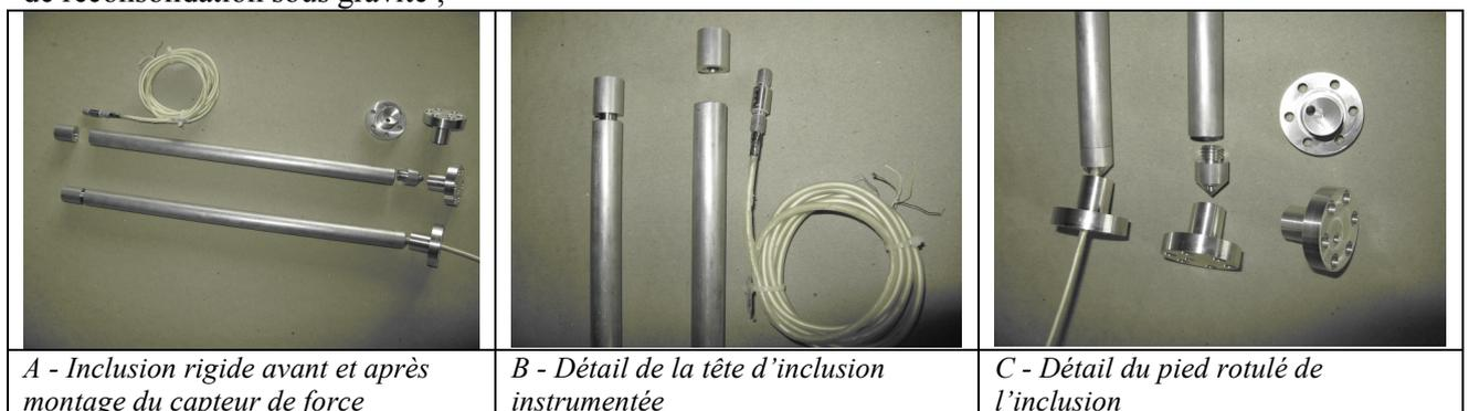
Figure 3 – Inclusion instrumentée (A) et détail des usinages pour insertion du capteur (B) et passage de câble dans le bouchon étanche (C)
