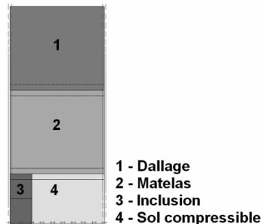
Figure 14. Schéma représentative du modèle avec un sol compressible
